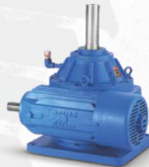
19. GETRIEBE FÜR KÜHLTURMGEBLÄSE mit verlängertem oberem Lagergehäuse und verstärktem Axiallager
